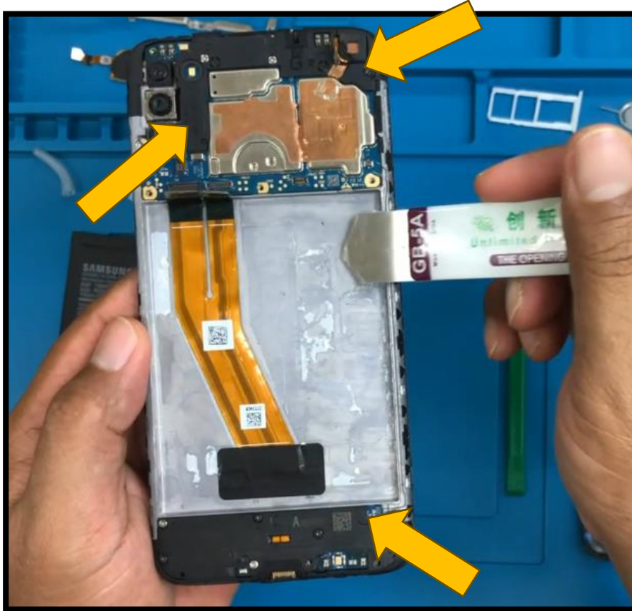
Rajah 3.8: Dua pelindung plastik yang perlu dibuka. Atas ialah papan induk dan dibawah ialah papan sekunder.
