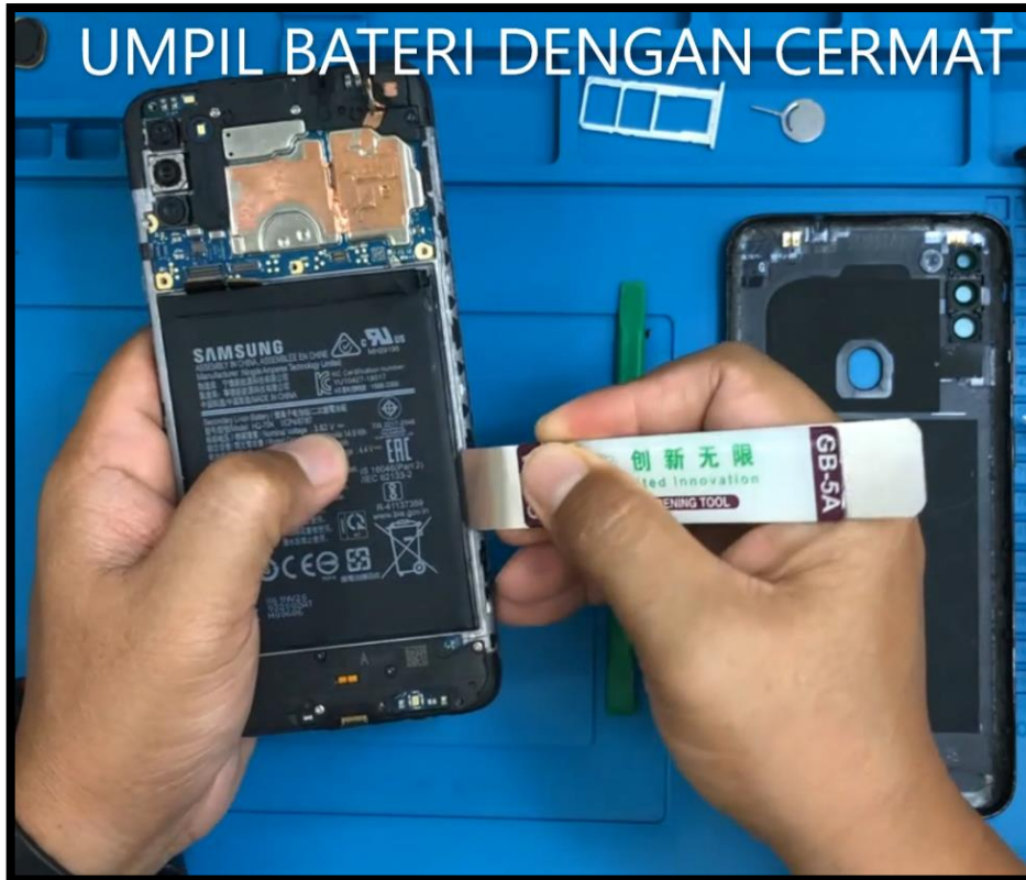
Rajah 3.6: Umpil bateri menggunakan pry tools
