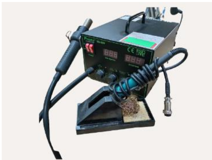
Rajah 2.7: Set rework station yang mempunyai alat pematrian dan blower
