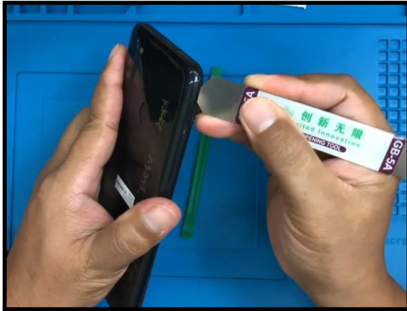
Rajah 3.3: Umpil pada kerangka plastik menggunakan pry tools
