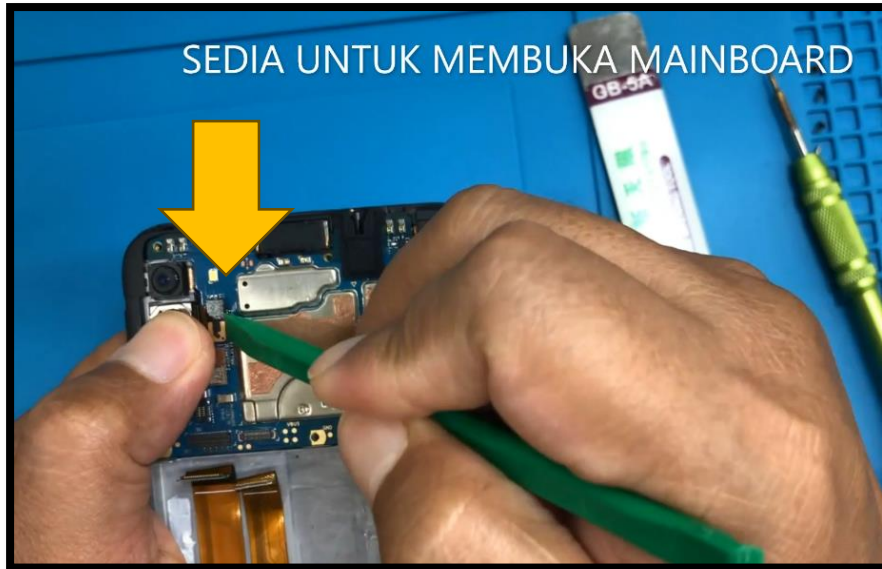
Rajah 3.15: Menanggalkan semua riben kamera dari papan induk untuk peleraian
