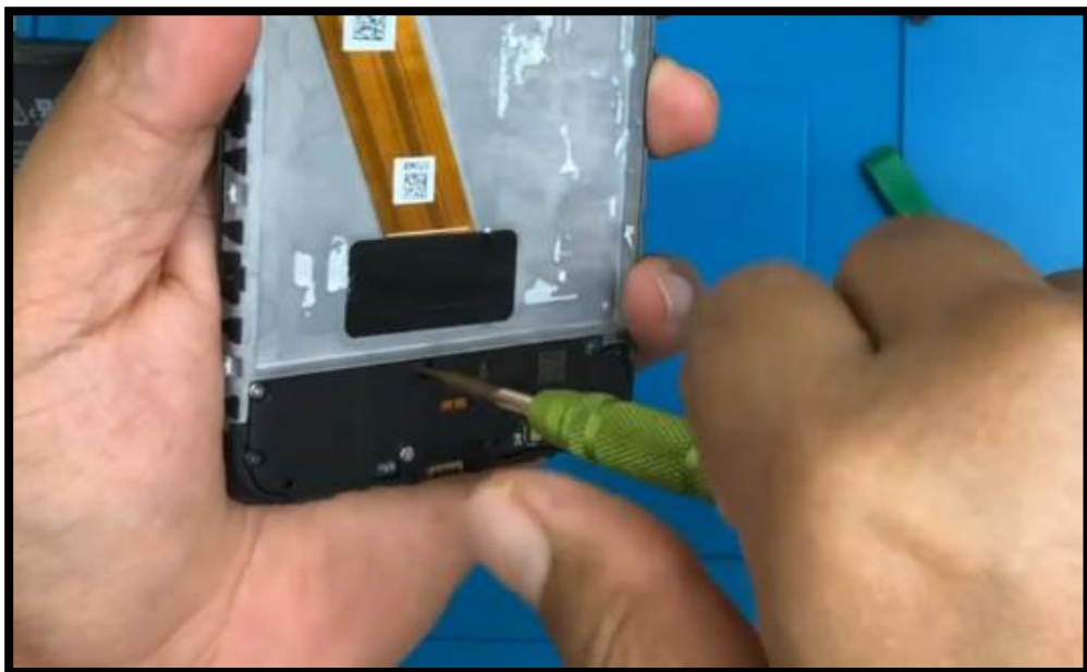
Rajah 3.10: Buka skru yang terdapat pada papan sekunder
